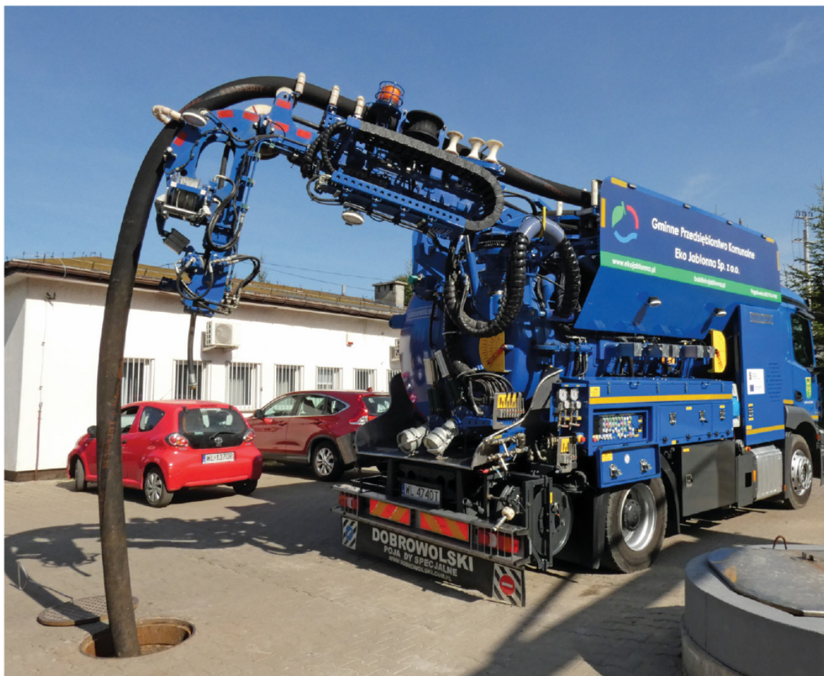
Fot. 4. Samochód specjalistyczny do czyszczenia kanalizacji sanitarnej
